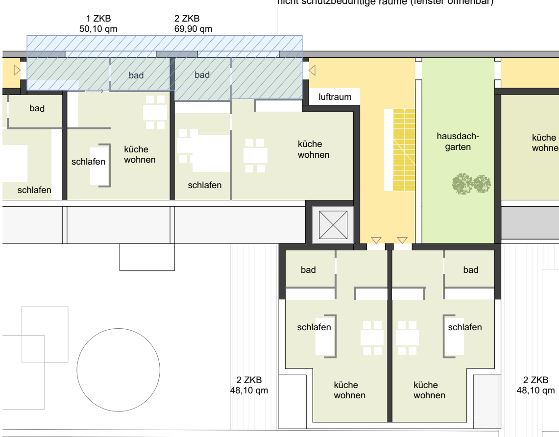
Grundrissbeispiele I Dachgeschoss I M 1:200
